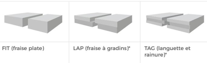
\* La superficie de couverture des planches avec une fraise est inférieure de 2 à 4 %.
